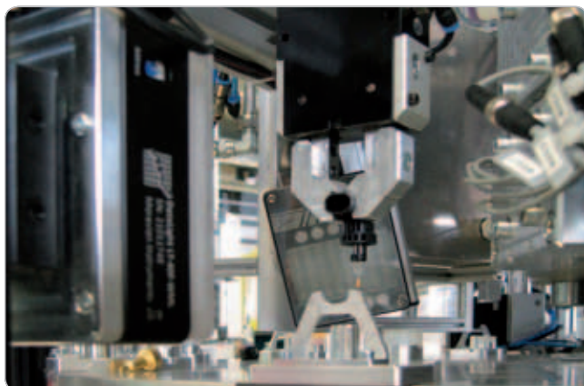
Obr. 3 Umiestnenie osvetľovacích jednotiek na automatu
