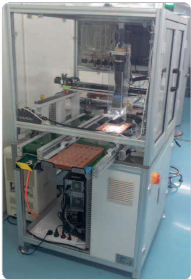
Obr. 3 Kontrolný systém s riadkovým skenovaním skontroluje každý zásobník obsahujúci 50 výliskov v časovom cykle 1,5 sekundy.
