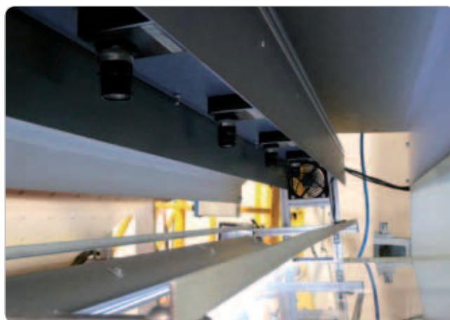
Obr. 4 Štyri kamery snímajú celú šírku dosky.
