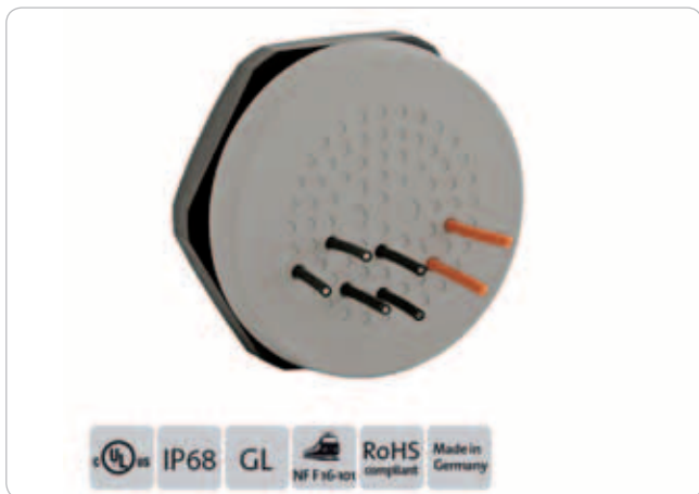
Obr. 4 Okrúhla priechodka KEL-DPZ na 78 káblov konektorov. Má veľkú variabilitu montáže s vložkami KT pre všetky druhy káblov s priemerom 2 až 14 mm.
