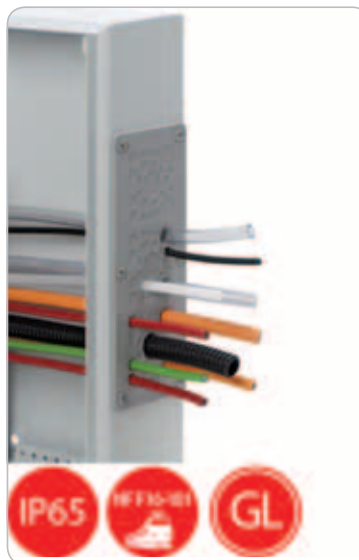
Obr. 4 Okrúhla priechodka KEL-DPZ na 78 káblov konektorov. Má veľkú variabilitu montáže s vložkami KT pre všetky druhy káblov s priemerom 2 až 14 mm.
