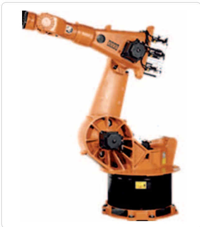
Obr. 2 d) antropomorfná konfigurácia [4]
