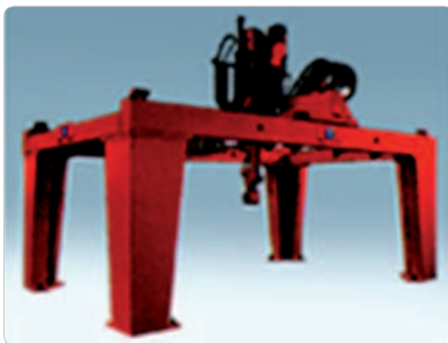
Obr. 2 a) karteziánska konfigurácia
