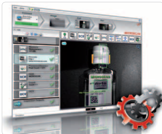
Obr. 2 Visionscape® od spoločnosti Microscan je výkonný softvér pre spracovanie obrazu, ktorý možno použiť spolu s kartami pre strojové videnie, riešeniami na báze GigE a inteligentnými kamerami
