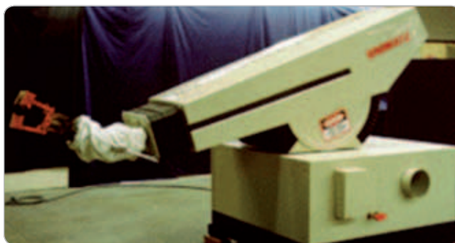
Obr. 2 b) polárna konfigurácia
