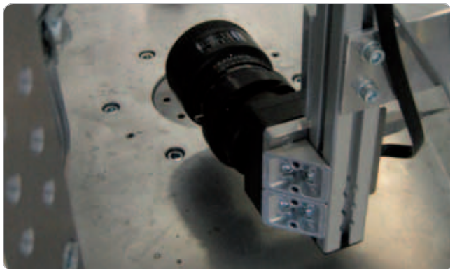
Obr. 2 Umiestnenie kamery na stroji tak, aby neprekážala žiadnemu mechanizmu automatu.
